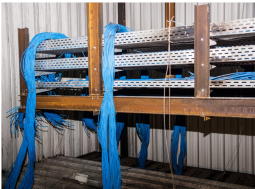
<케이블 트레이, 케이블 및 목재를 고려한 실물화재에 대한 화재하중>
