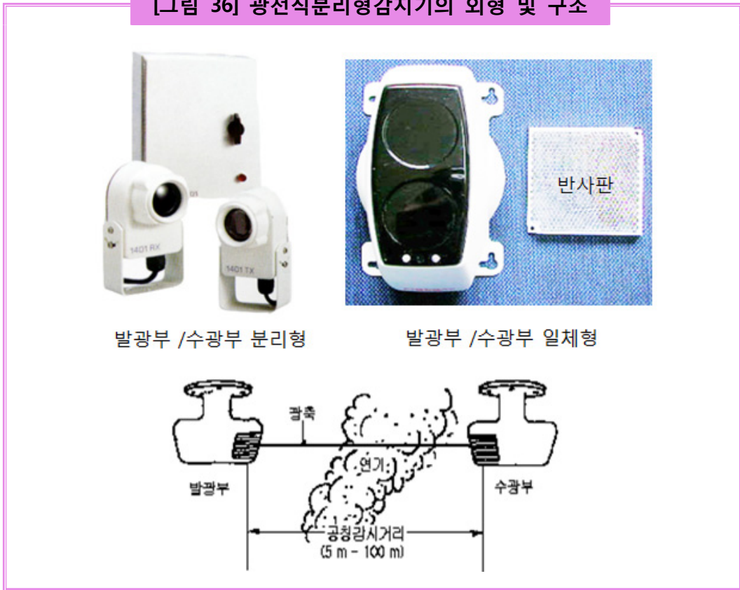
[그림 36] 광전식분리형감지기의 외형 및 구조
