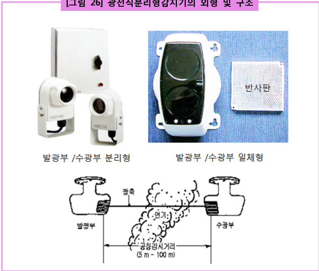
[그림 26] 광전식분리형감지기의 외형 및 구조
