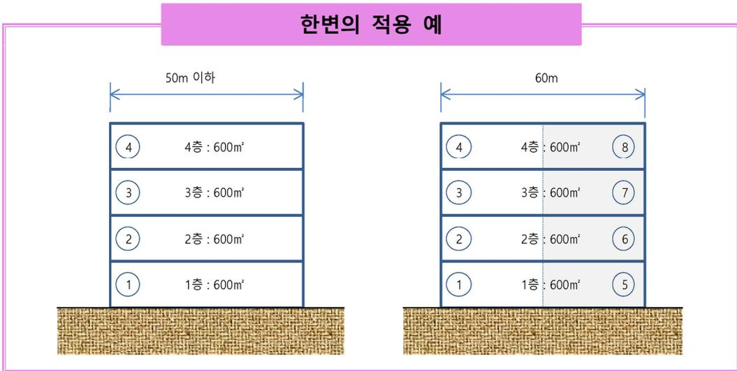
2. 하나의 경계구역이 되기 위한 조건은 면적이  $600\text{m}^2$  이하이고 한변의 길이가  $50\text{m}$  이하가 되도록 2가지 조건이 모두 충족되어야 한다.
