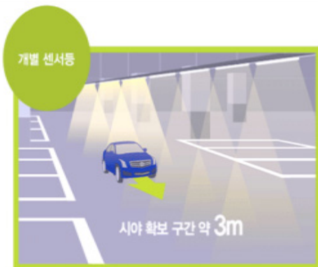
차량이 센서등에 가까이 접근했을 때에 이를 인식한 센서등만 켜지므로 이미 차량이 지나간 후에 조명이 밝아지는 오류가 있을 수 있습니다
