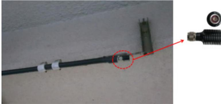
그림은 무반사 중단저항(Dummy load)으로 특성 임피던스는 50Ω을 표준으로 하나 주파수 대역, 주파수대역 정재파비, 최대 입력값, 접속 커넥터의 형식이 정해져야 한다. 무반사 중단저항은 방열특성이 중요하며 특성상 끝부분에 방열판이 설치되어 있다.
